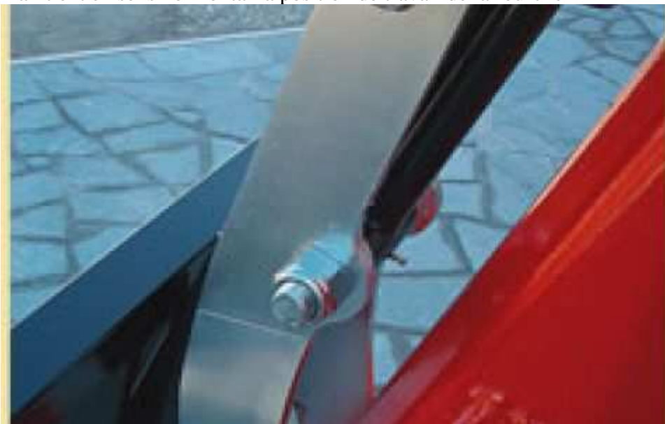
1) Parallélogramme qui maintient en sens horizontal la position de travail de la fourche
