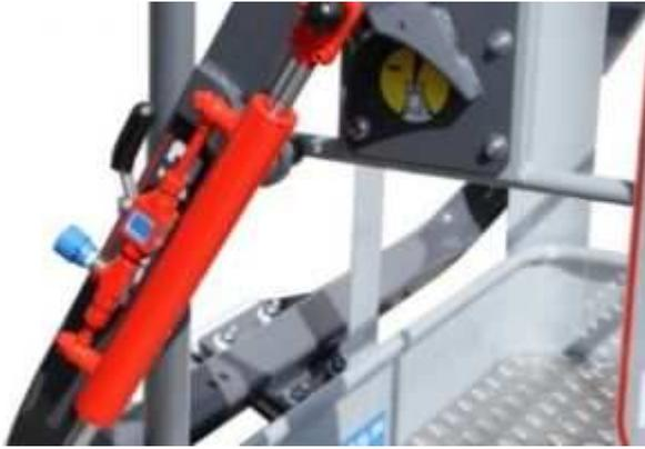
CILINDRO stabilizzatore con valvola regolatrice
