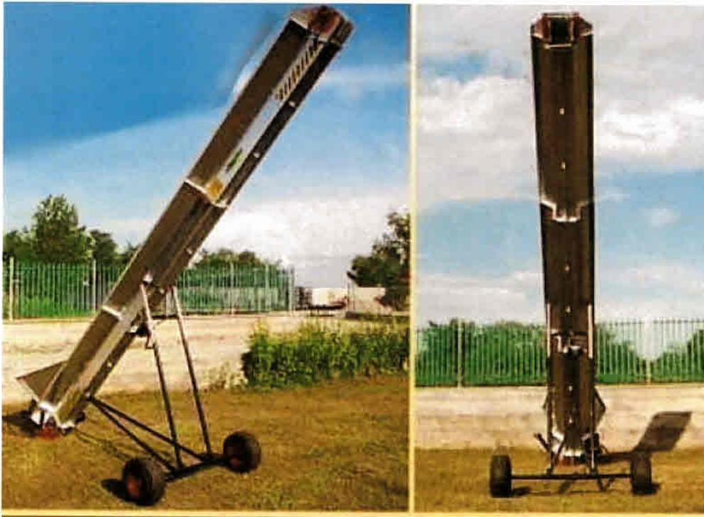
Questo **nastro trasportatore per legna** ha una struttura composta da settori zincati fissati tramite bulloni, che consente la riduzione delle dimensioni di ingombro in fase di trasporto.
