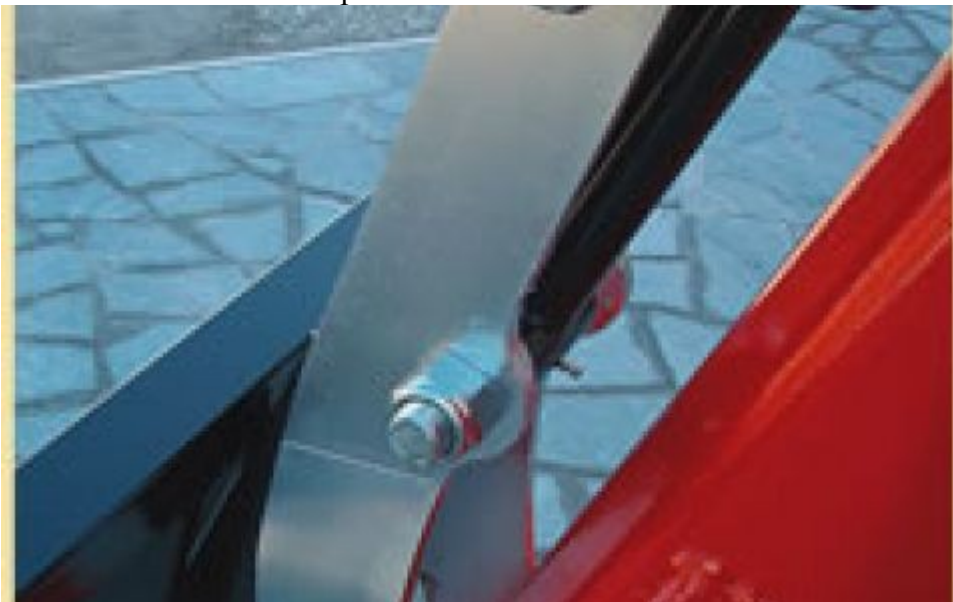
1) Parallelogramma che mantiene in orizzontale la posizione di lavoro della forca
