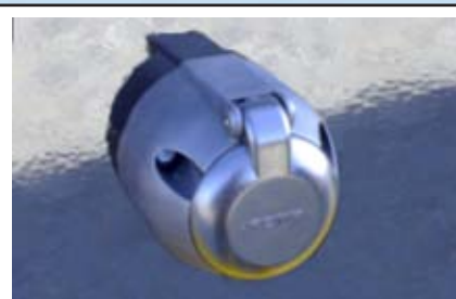
Presa di corrente per l'alimentazione dell'impianto di illuminazione.
