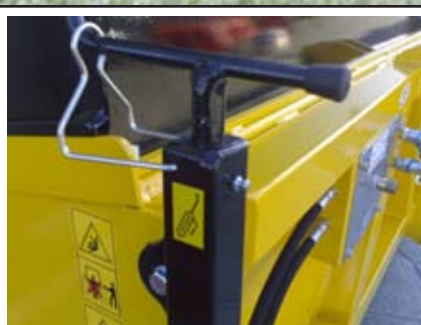
Piedi laterali per la regolazione della ritenuta delle molle di distribuzione.
