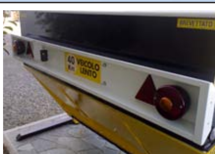
Impianti di illuminazione posteriore utilizzato durante il trasporto su strada.
