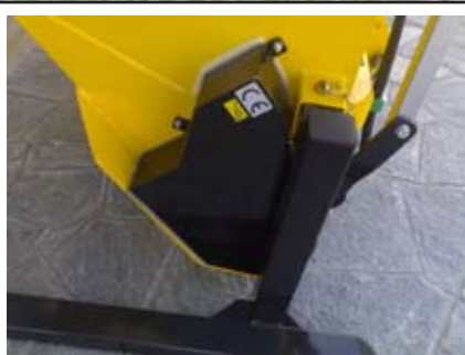
Catena di trasmissione esterna protetta da carter per impedire il contatto con gli ingranaggi in movimento.
