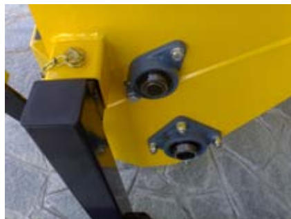
Cuscinetti laterali soggetti ad ingrassaggio ogni 30 ore di lavoro
