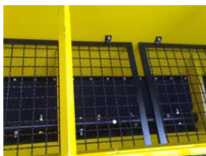
Rete di protezione interna per impedire il contatto con le parti in movimento.
