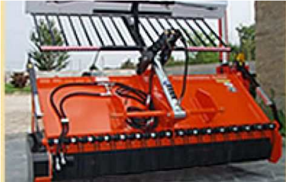
Griglia di protezione con sistema di TECNOPLUS in posizione di carico sale (aperta)
