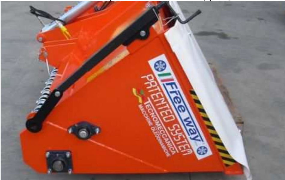
Griglia di protezione con sistema di TECNOPLUS in posizione di carico sale (aperta)
