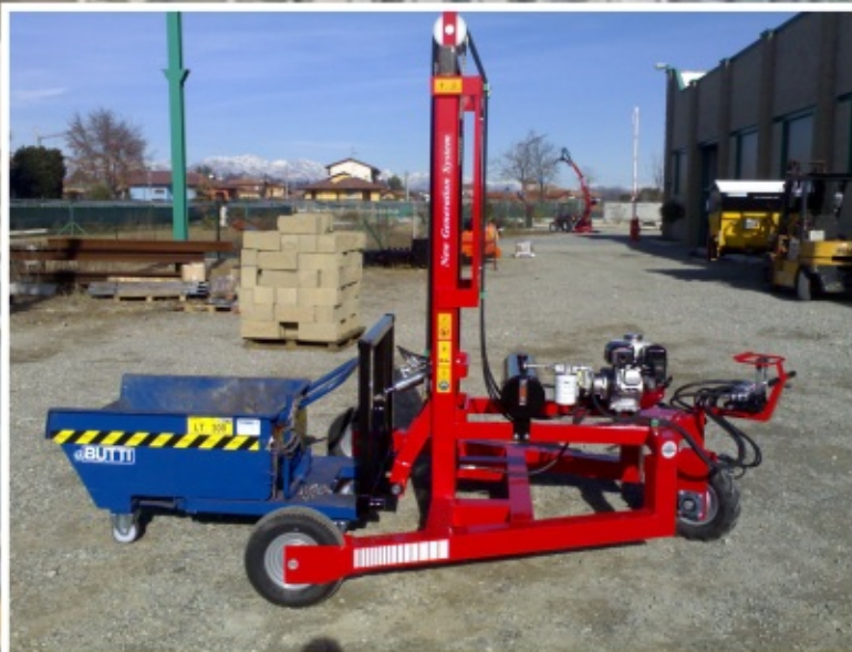
Sollevatore utilizzato con benna a ribaltamento idraulico mediante leva di comando ausiliaria.
