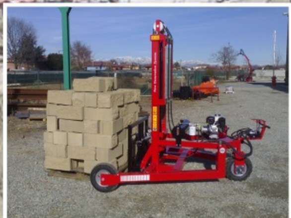
Sollevatore utilizzato con forche per la movimentazione di rotoballe o pallet.
