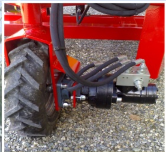
Freno idraulico applicato sulla ruota motrice (non appena si lascia la leva il sollevatore si arresta).
